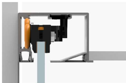
FALSO TECHO A DINTEL
